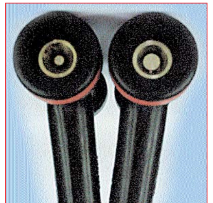
Austrittsdüsen der Pistolen links MK2 5/16" rechts MKMV 9/16" für Typ 2000
